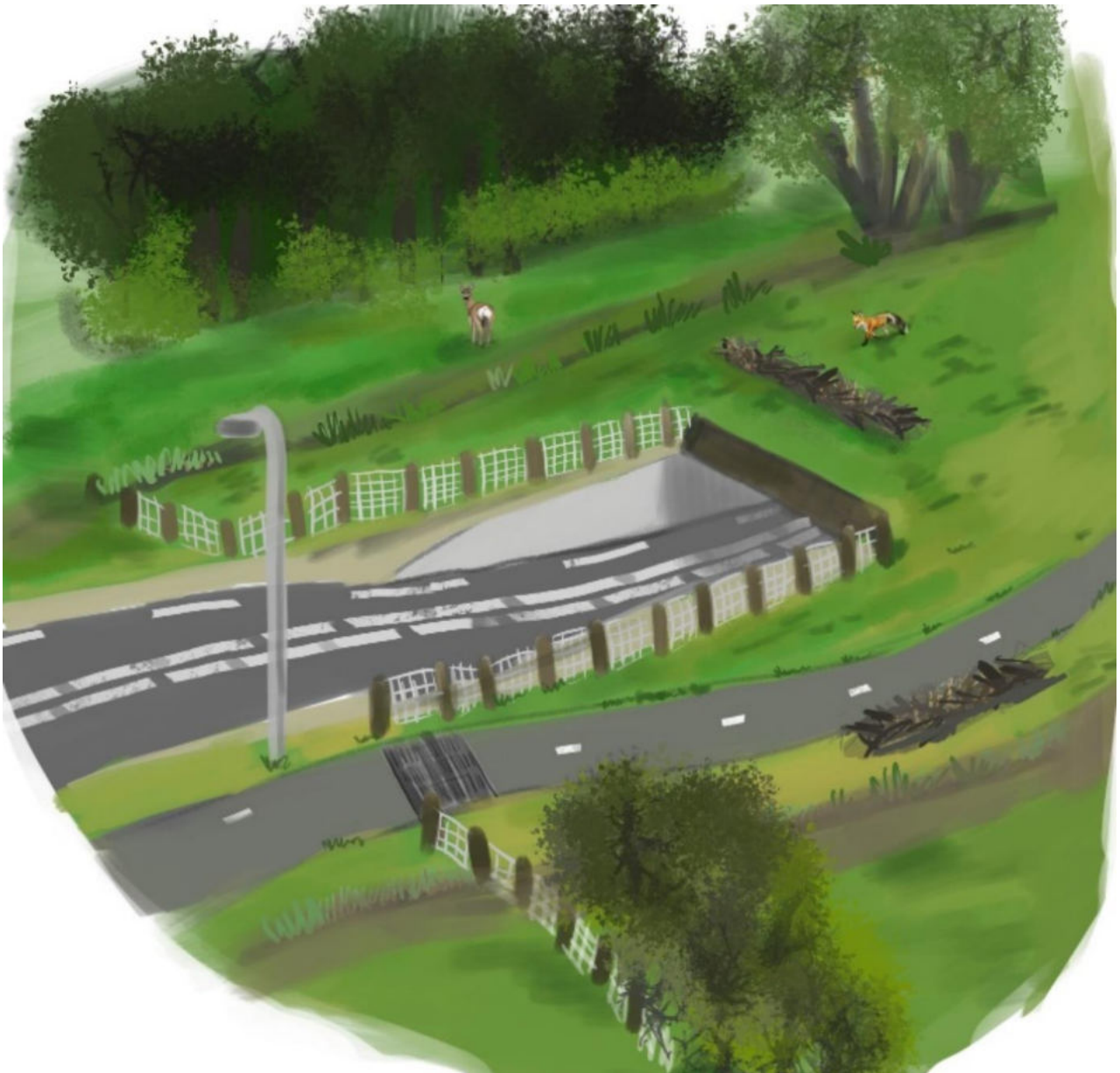
Figuur 16.22 | Artist impression van een oplossing voor een knelpunt, waarbij de N234 net noordelijk van de splitsing met de Embranchementsweg onder het maaiveld door loopt, zodat de graslanden aan de zuidzijde met het landgoed Pijnenburg op de achtergrond verbonden worden.
